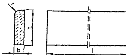
Rysunek 1. Kształt betonowego obrzeża chodnikowego
