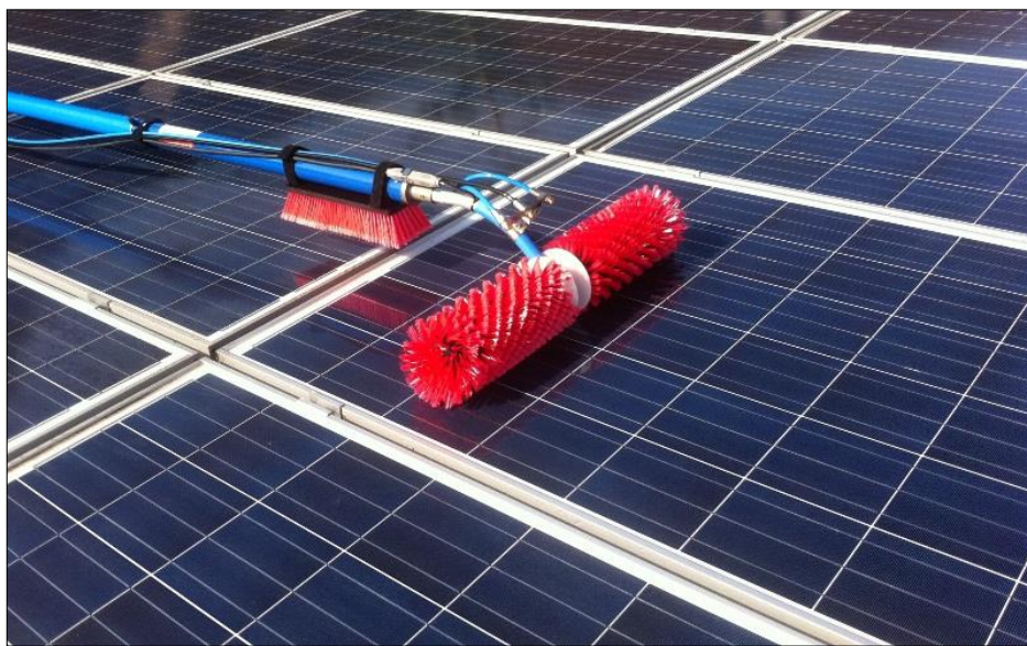
Fot. 3-2: Szczotka do czyszczenia paneli fotowoltaicznych ( https://lewi-polska.pl/pl/ )
